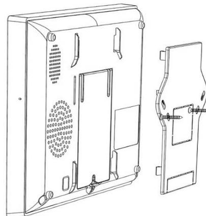
2. Richten Sie das Loch auf der Rückseite des Hauptmoduls an der Aufhängeplatte aus und installieren Sie es.
