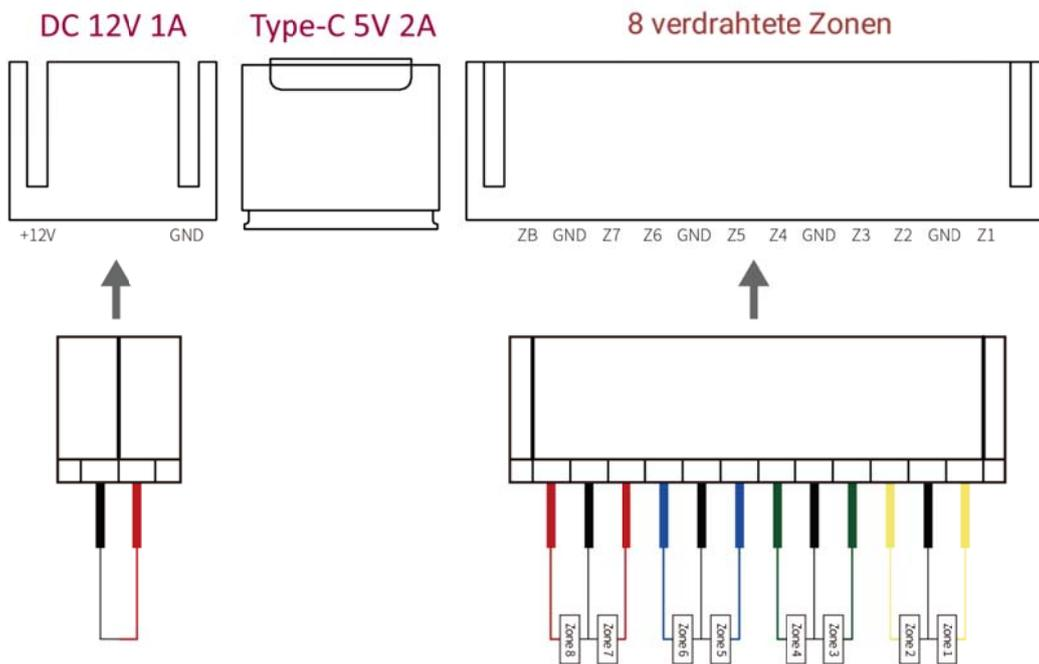
Hinweis: Stromschnittstelle: 12V/1A und 5V/2A USB-C-Anschluss, bitte verwenden Sie nur eine Schnittstelle, nicht gleichzeitig anschließen und verwenden.
