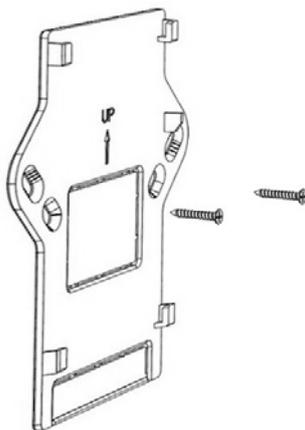
1. Befestigen Sie die Wandhängeplatte mit Schrauben an der Wand.
