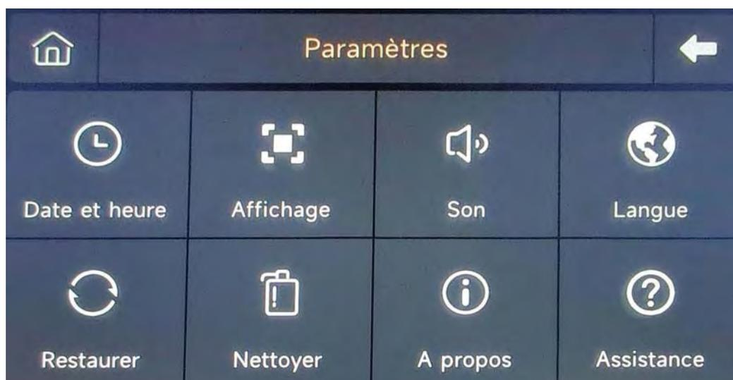
(2) Heure : Permet de régler l'heure et d'ajuster le format d'affichage de la date.
